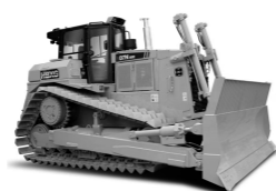
推土机装有宽大履带
