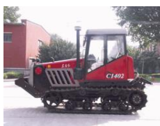
拖拉机装有宽大的履带
